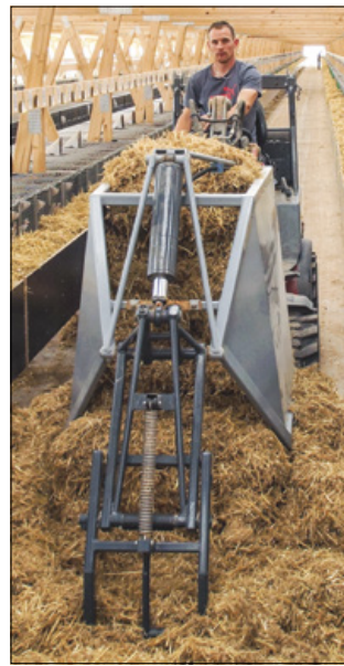
Thyrrerstrup halsamler fjerner al halmen på én gang og efterlader en fint rensede gang. Den er fremstillet af højstyrkestål, og egenvægten er så lav, at den kan benyttes af selv små minilæssere. På billedet ses udviklingschef Sergejs Boisko.
